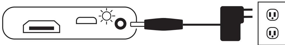
2. De groen knipperende LED-indicator geeft aan dat de accu wordt opladen.
