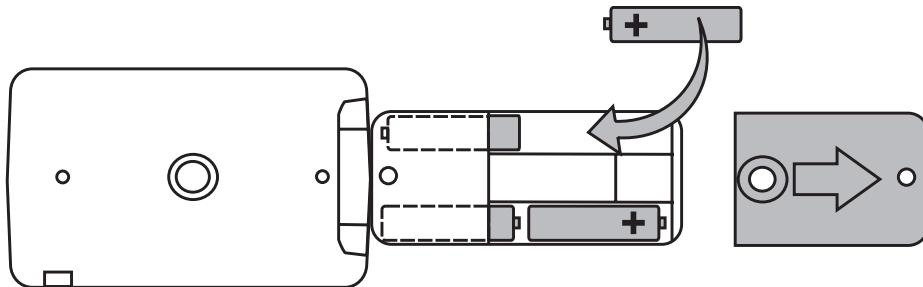
Opmerking: Gebruik accu's (NiMH-accu's) niet tegelijkertijd met niet-oplaadbare alkalibatterijen. Vervang steeds alle batterijen door dezelfde soort batterijen. Vermeng geen nieuwe batterijen met oude batterijen. Vervang accu's (NiMH-accu's) door 1000 mAh-accu's. Niet-inachtneming van deze voorzorgsmaatregel kan ertoe leiden dat de batterijen niet functioneren of lekken.
