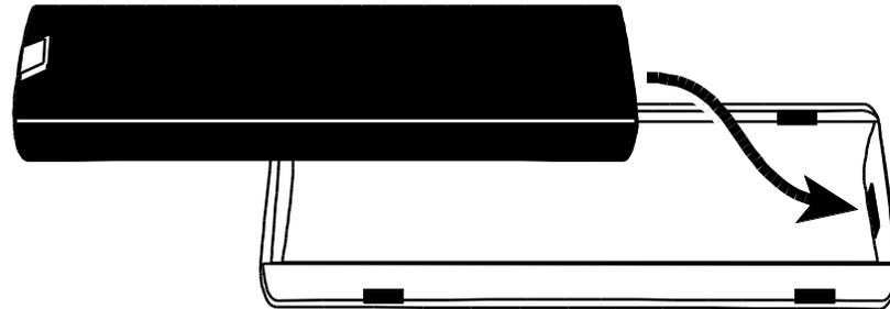
2. Alignez les languettes de verrouillage du couvercle de la batterie avec les fentes du compartiment de la batterie, et faites coulisser le couvercle jusqu'à fermeture. Vérifiez que la languette en plastique reste bien à l'intérieur du compartiment.
